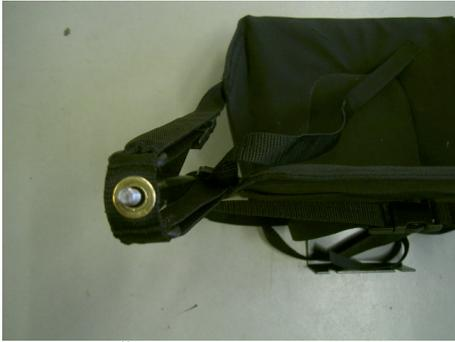
Bild 12, Ösen über Rohrgewinde
