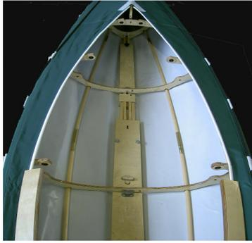
Bild 9, eingesetzte Spanten
